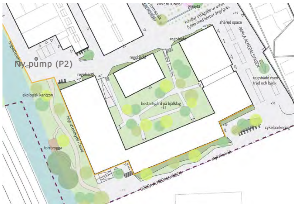
Figur 42 ARO E dagvattenhantering i regnbäddar längs norra fasaden på ny byggnad
