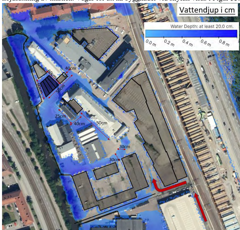
Figur 32 Skyfallsmodellering ifrån MIKE 21 illustrerad i Scalgo. Vattenansamlingar med djup mindre än 20cm visas inte i figuren. Bild illustrerar största vattendjupet och utbredningen som sker under simuleringen för planområdet med planerad höjdsättning av marken. Djupet varierar inom de blå områdena (djup under 20cm visas ej). Det varierar också över tid i takt med att vattnet sjunker undan. Bild visar vid värsta tidpunkten. Röda pilar visar infartsväg till planområde.
