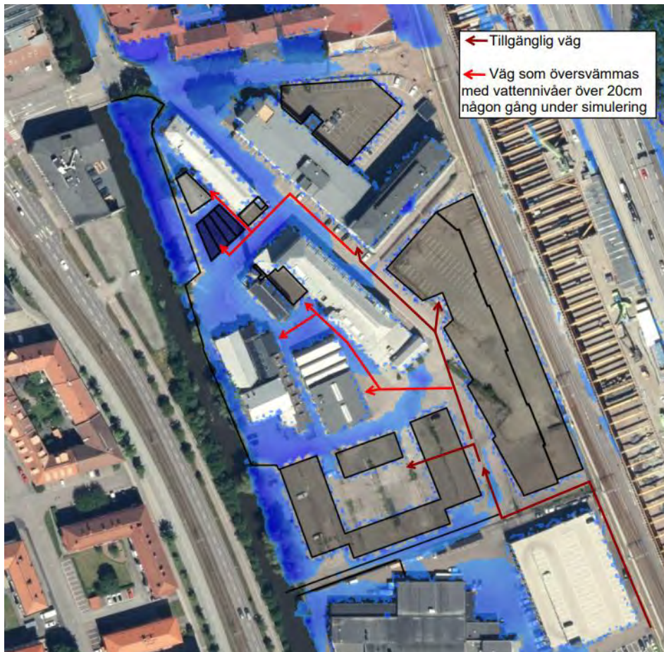
Figur 33 Tillgängliga vägar enligt skyfallsmodellering ifrån MIKE 21 med framtida höjdsättning på mark illustrerad i Scalgo. Vattenansamlingar med djup mindre än 20cm visas inte i figuren.
