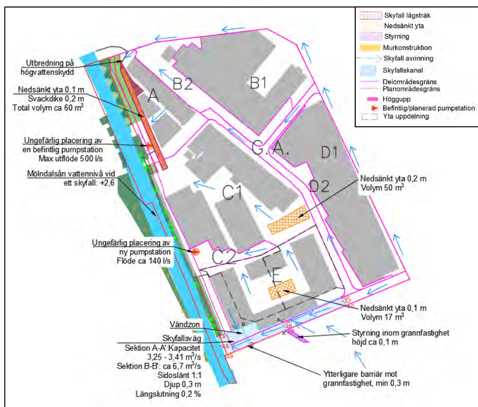
Figur 43. Principskiss för skyfallshantering. Skyfallsavrinning markeras med blå pilar
